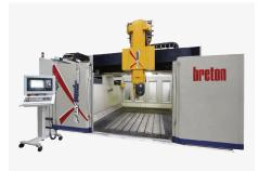
'Y' Axis : 8500 MM 'X' Axis : 4000 MM 'Z' Axis : 2500 MM 'A' Axis : (±) 120°
