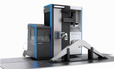
'X' Axis : 6000 MM 'Y' Axis : 3500 MM 'Z' Axis : 1500 MM 5-Axis Universal Head
